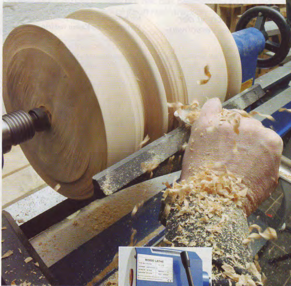
Bei laufendem Motor lässt sich die Drehzahl mit diesem Hebel in zehn voreingestellten Bereichen einstellen
