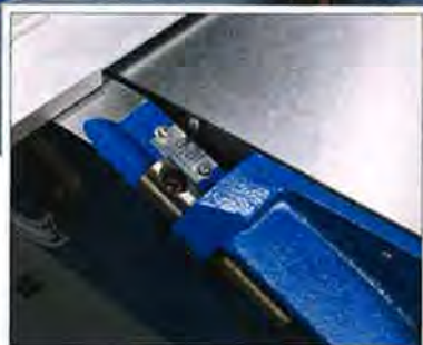
Schlicht und wirkungsvoll: die Skala für die Spanabnahme der Abrichte
